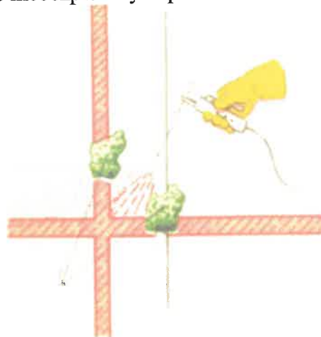
Rys.3. Wszelkie otwory i szczeliny prowadzące do sąsiednich pomieszczeń pozostające w zasięgu rozprysków spawalniczych powinny być uszczelnione materiałem niepalnym (1).
